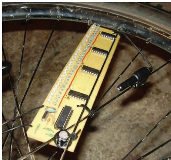
Obr. 7. Ukážka namontovaného displeja na kolese bicykla
